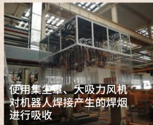
机器人焊接烟尘治理措施和效果
